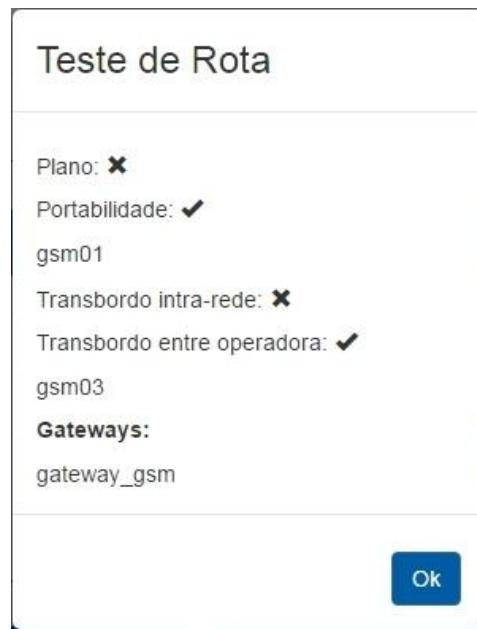
No exemplo acima, o número testado não pertence ao plano, foi consultado na portabilidade, utilizando o canal GSM 1, não ocorreu transbordo intra-rede, mas ocorreu transbordo entre operadora saindo pelo canal GSM 3. Essa ligação saiu pelo gateway SIP4 – GSM configurado como “gateway\_gsm”.
