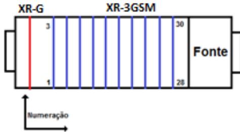
A numeração das interfaces quanto a sua posição no bastidor é crescente, de baixo para cima, da esquerda para a direita, como pode ser visto na imagem acima, assim como nas placas FXS.
