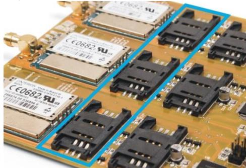
As placas **XR-3GSM** são as placas responsáveis pelas linhas GSM do bastidor. Cada placa **XR-3GSM** contém três linhas GSM. Cada canal do **Pináculo® XR** apresenta três LEDs que fornecem as seguintes indicações.
