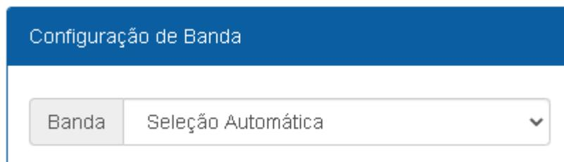
**Banda:** Permite ao usuário alterar a forma de seleção de banda do módulo GSM, neste caso, permite que seja selecionada se necessário fixar o módulo GSM a operar em somente em 2G ou 3G.
