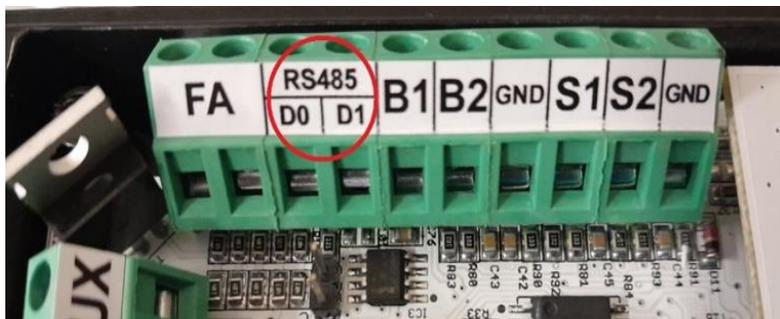
O borne D0 do Bravo corresponde ao borne B do T-BOX, e o borne D1 ao borne A do T-BOX.
